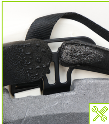
Füllung mit Flammenbrandspuren
