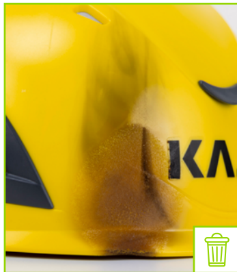
Außenschale mit Flammenbrandspuren
