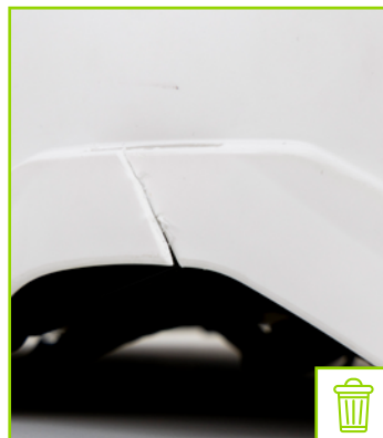
Zubehöraufnahmeschlitz mit Rissen
