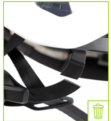
Gebrochene Zahnstange des Verstellsystems
