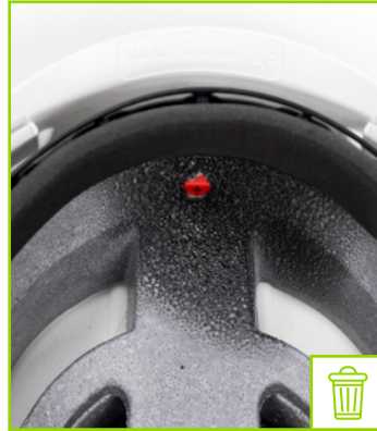
Innenschale mit Flammenbrandspuren
