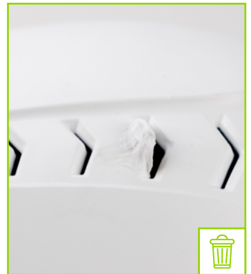
Außenschale mit verformtem Lüftungsloch
