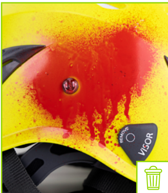
Außenschale mit Farbanhaftungen
