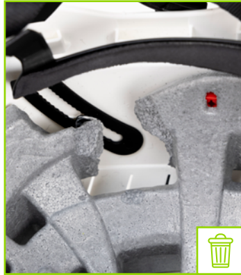
Innenschale mit fehlendem Teil
