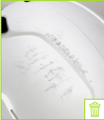
Außenschale mit tiefen Einschnitten
