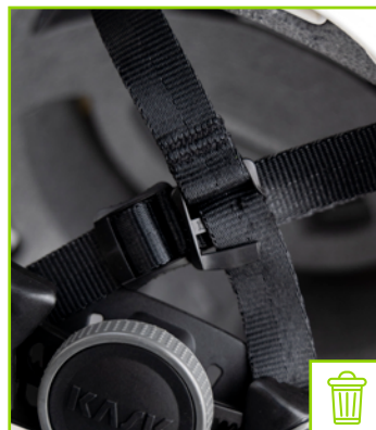
Hintere Verstell Schnalle gebrochen
