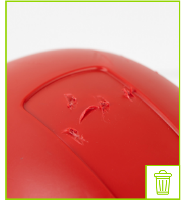
Außenschale mit Schlagverformung
