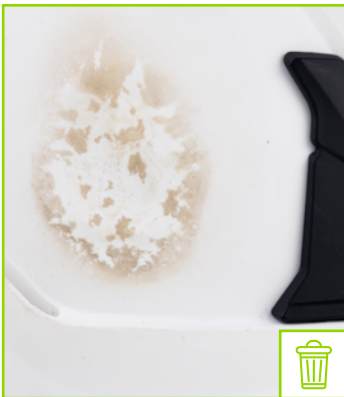
Außenschale mit Spuren einer chemischen Substanz
