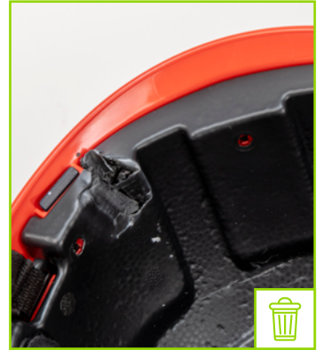
Innenschale mit Verformung
