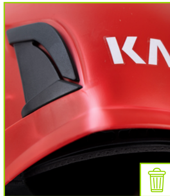
Außenschale mit Verformungen
