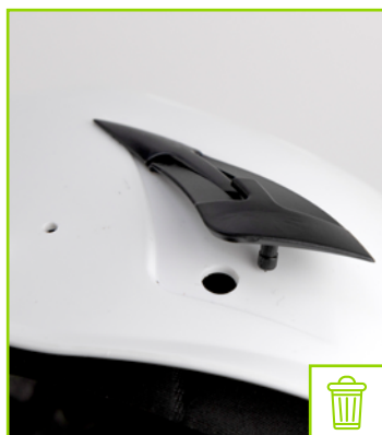
Clip para uso de linternas desprendido
