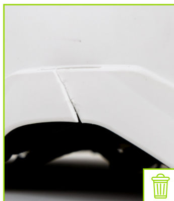
Ranura de fijación de accesorios agrietada
