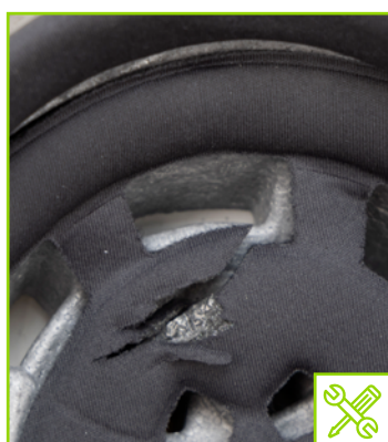
Acolchado interno agrietado
