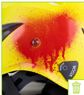
Carcasa con presencia de pintura
