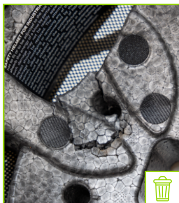
Carcasa interior agrietada
