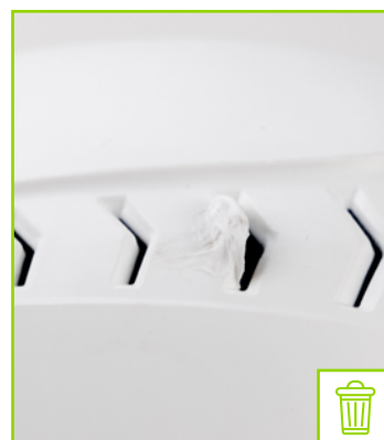
Carcasa con orificio de ventilación deformado
