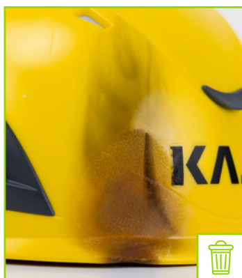
Carcasa con marcas de quemaduras de llama
