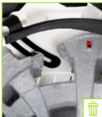
Coque interne avec partie manquante
