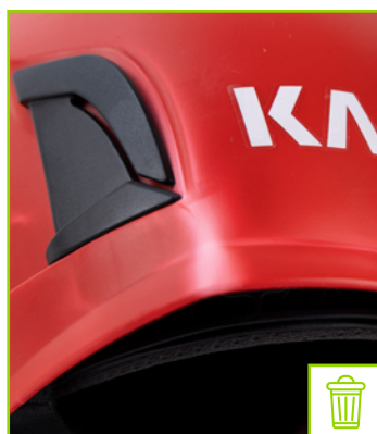
Coque externe avec déformation
