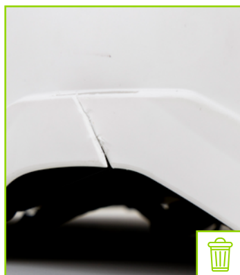
Fessura di fissaggio accessori fessurata
