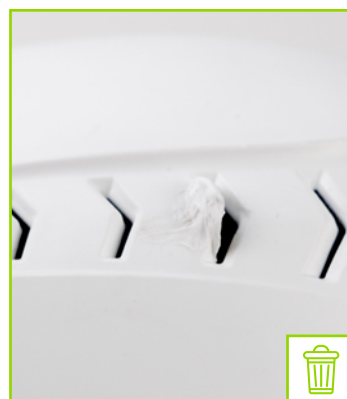
Calotta con foro di aerazione deformato
