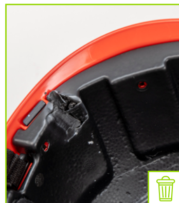
Calotta interna con deformazione
