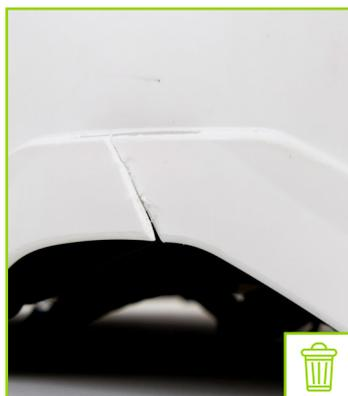
Fente de fixation accessoires fissurés
