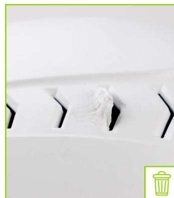
Coque externe avec trou de ventilation déformé
