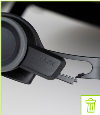
Sistema di regolazione rotto
