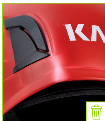
Calotta con deformazione
