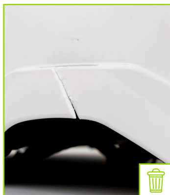
Fessura di fissaggio accessori fessurata
