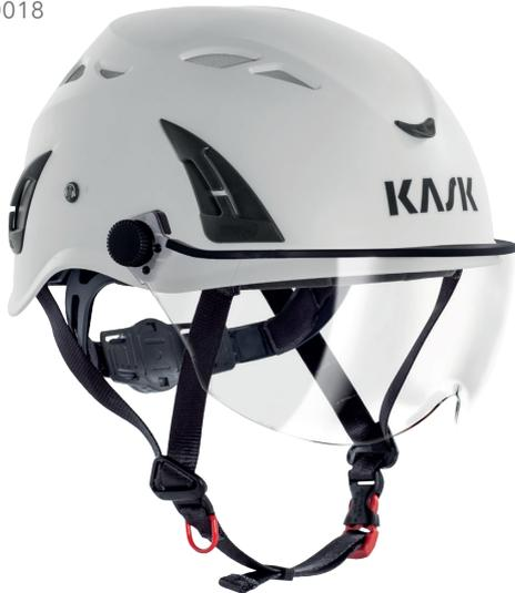
Polycarbonatvisier, kompatibel mit allen Helmen der Plasma-, Superplasma- und HP-Serie. Entspricht der Norm EN 166 für Augenschutz von Arbeitnehmern vor Stößen mit mittlerer Energie. Kann mit dem Visierschraubensatz Plasma V2 angebracht werden. Sicheres Heben und Senken. Erhältlich in 3 Scheibenfarben für unterschiedliche Lichtdurchlässigkeiten.
